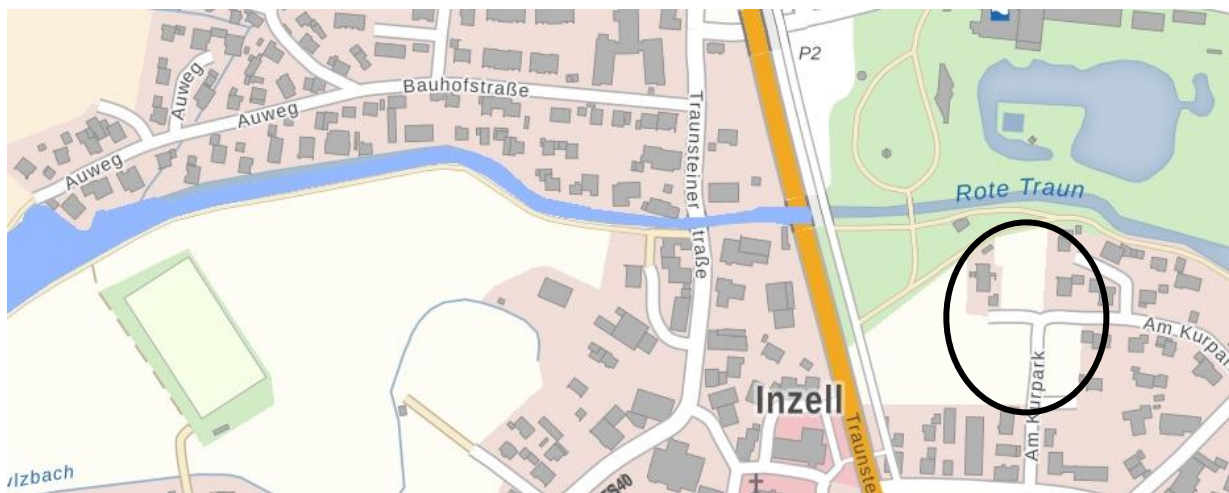
Abbildung 8: Hochwassergefahrenflächen für ein hundertjähriges Hochwasser HQ100 (blau) westlich des Plangebietes (schwarzer Kreis), Quelle: BayernAtlas/Naturgefahren
